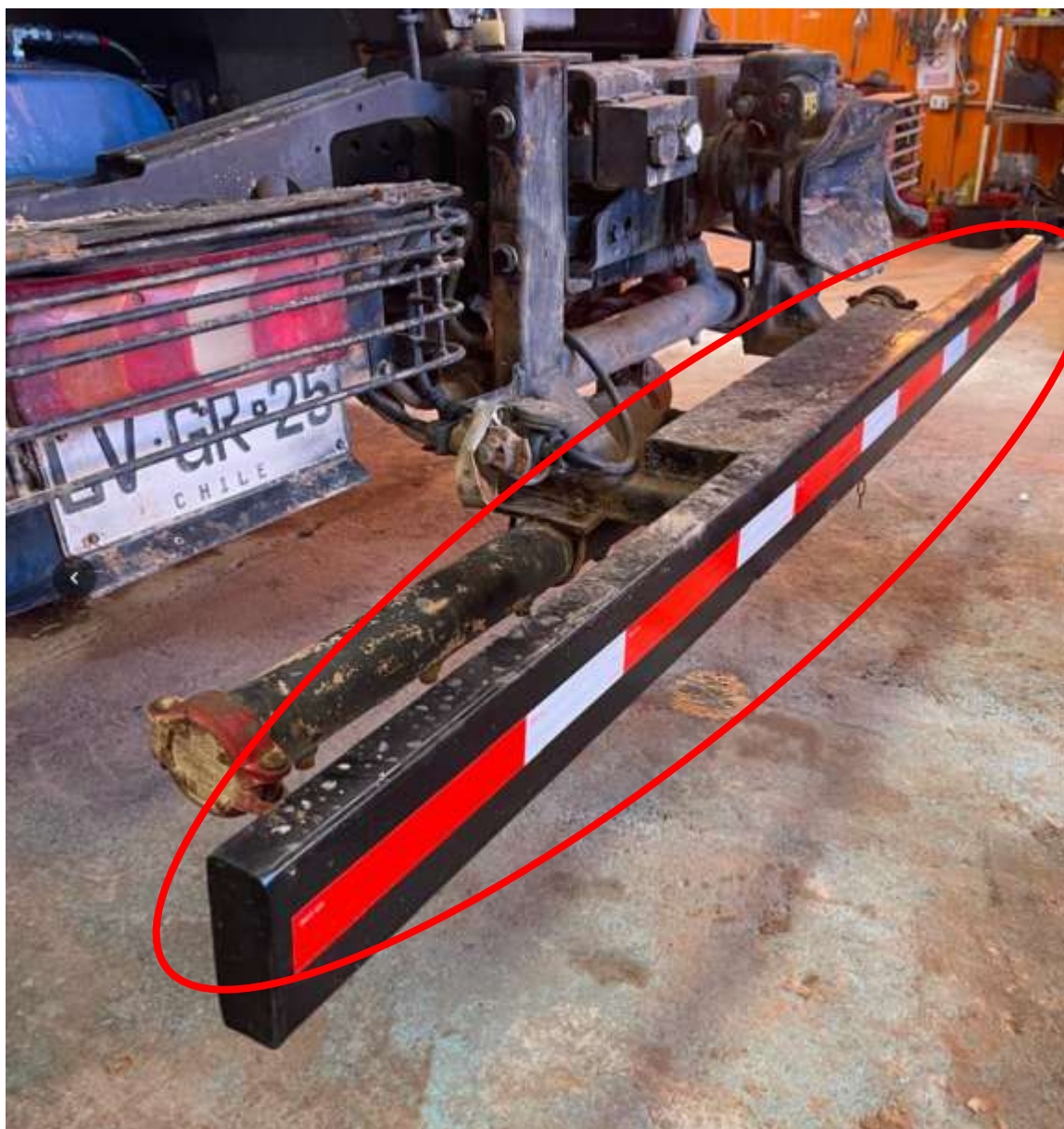
Parachoques fabricado he instalado.
