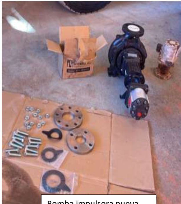
Bomba impulsora nueva
